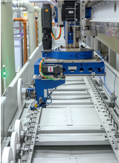
3 Über das Ladeportal werden die Maschinen mit Werkzeugen versorgt
